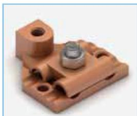
Cette pièce permet de supporter les pointes de Ø10 (tableau 6) au toit et de les connecter au câble ou au conducteur rond. Son utilisation avec des pointes d'1m n'est pas recommandée.
